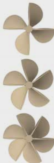
Elica di superficie con retromarcia per scafi plananti ( surface piercing propeller with backgear for planing vessels )
