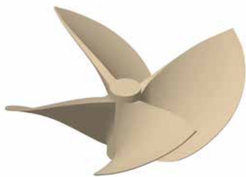
Elica di superficie per scafi plananti. ( surface piercing propeller for planing vessels )
